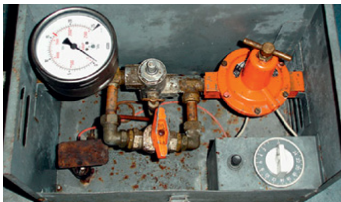
Automatikenhet för tidsinställning och reglering av effekt. Utrustad med slangbrottsventil och manometer för läckagekontroll.
