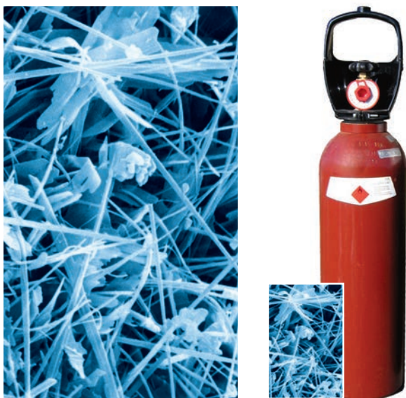
10.000 gångers förstoring av den porösa massan i en acetylenflaska (fotograferad i svepelektronmikroskop).
