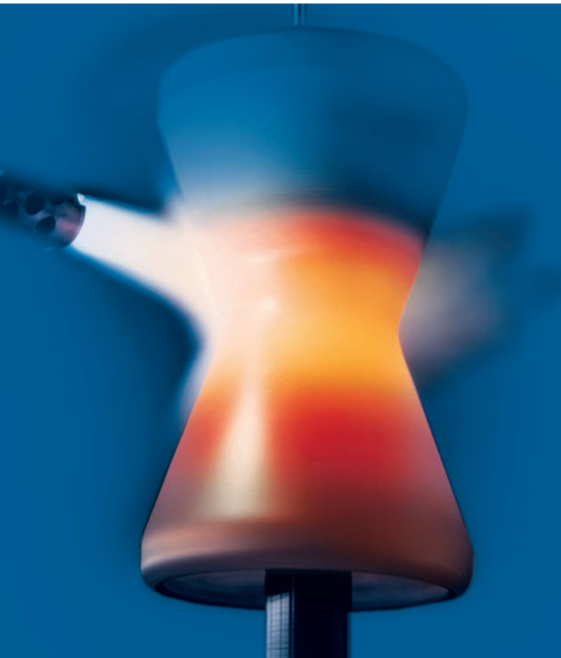
Automatisk beläggning med CrNiBSi, som sprutats på ett linshjul med hjälp av flamsprutning.
