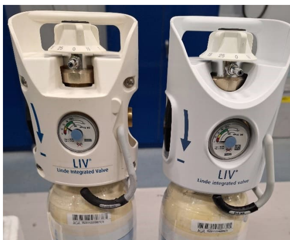
Bilde 1: Til venstre kan man se den gamle versjonen av plastbeskyttelsen, og til høyre er den nye.
