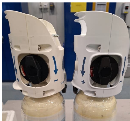
Bilde 2: Til venstre kan man se den gamle Versjonen av plastbeskyttelsen, til høyre er den nye.
