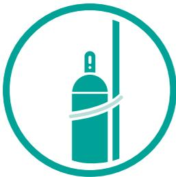
4. Sujeta el cilindro a un punto fijo. Evita caídas.
