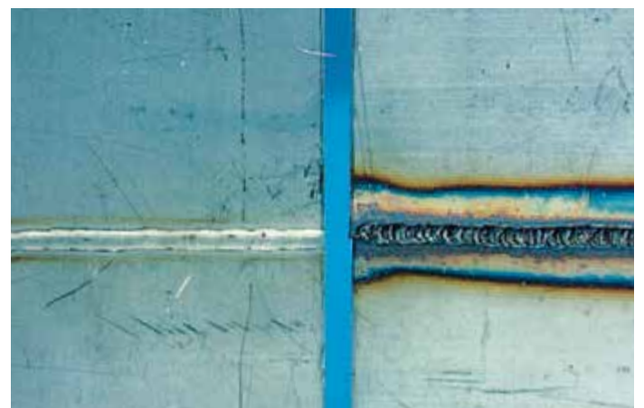
Vasemmallä juurensuojakaasulla FORMIER® 10 suojattu juuripinta. Oikealla hitsauksen aikana suojaamattomana ollut juuripinta.
