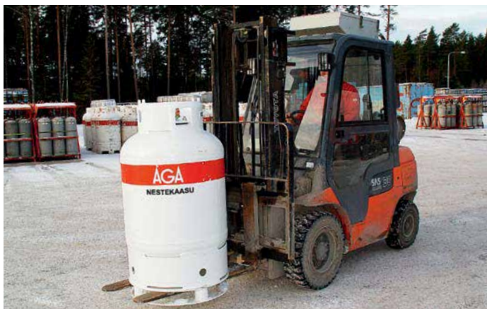
184 kg:n maksipullo nestekaasua. Pullossa on erilliset lähtöliitännät kaasulle ja nesteelle.
