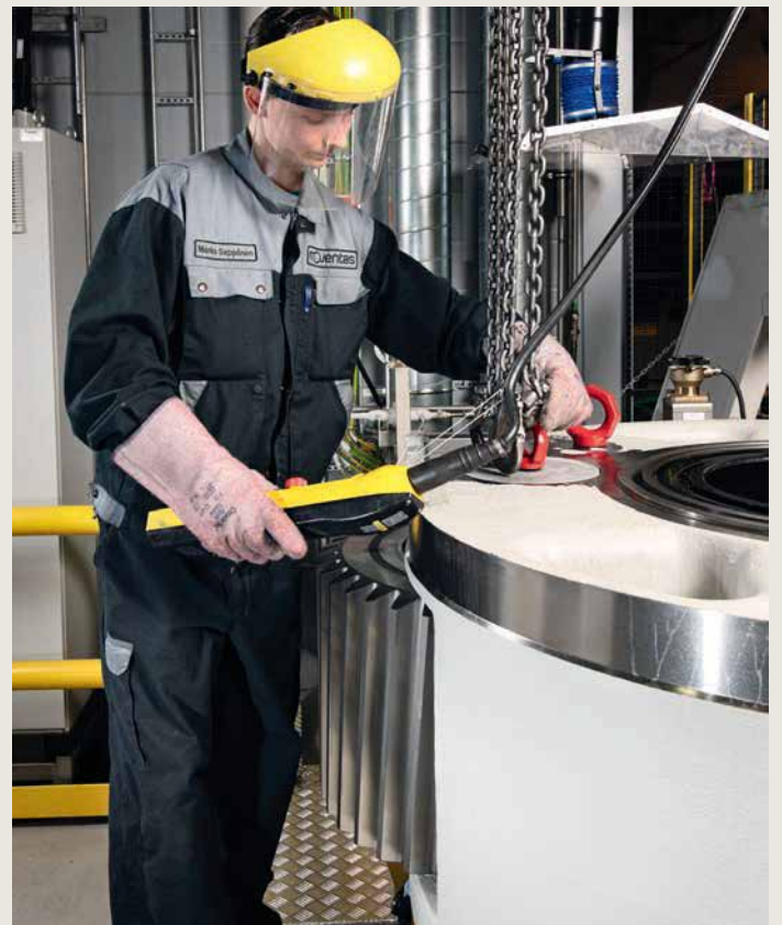
Kuvat 5 a - d. Nestemäisellä tyypellä jäädytetyn akselin asentaminen hammaspyörään. Moventas Wind Oy Jyväskylä. Kuvissa lämpökäsittelijä Marko Seppänen.
