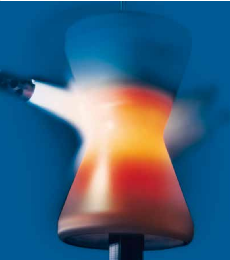
CrNi-BoSi-seoksen automaattista sulatusta ja ruiskutusta köysipyörän pinnalle jauhetäyteaineella ja liekkiruiskutusprosessilla.
