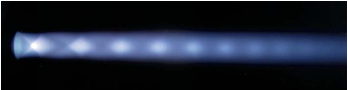
Rombos de choque durante la metalización con llama a gran velocidad
