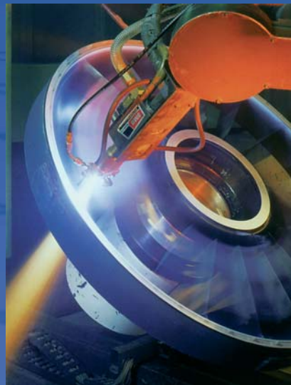
Proyección térmica con plasma de partes de un motor
