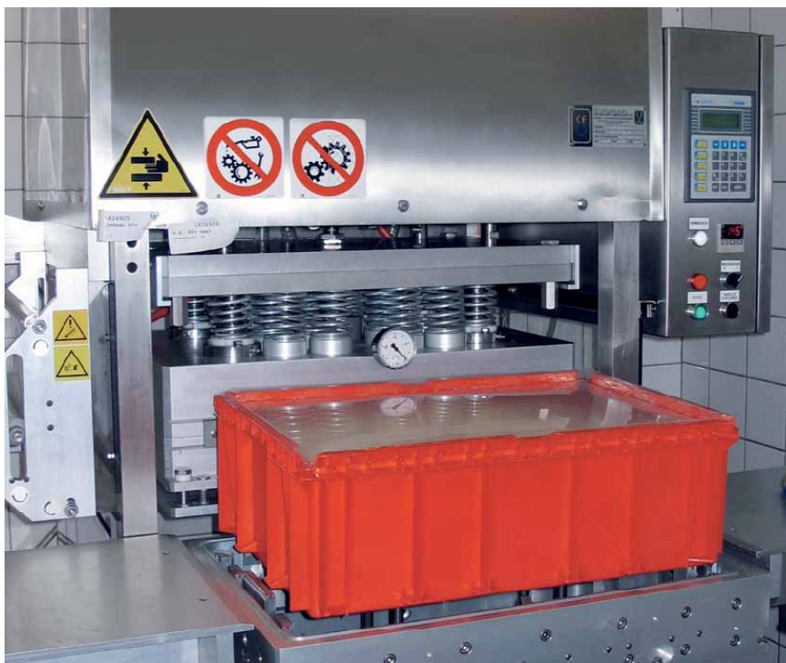
Creación de una atmósfera protectora en recipientes reutilizables
