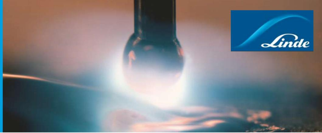
Für das MAG-Schweißen von Baustählen mit Massivdrahtelektroden sind alle Schutzgase der CORGON®-Reihe und CO<sub>2</sub> geeignet. CORGON® 18 (M21-ArC-18 nach ISO 14175) ist das universelle Schweißschutzgas mit guten Schweißigenschaften und tiefem Einbrand. Es ist auch an verzünderten Oberflächen gut einsetzbar. Die geeigneten Mischgase unterscheiden sich in Schweißverhalten, Schweißdateneinstellung, Nahtformung, Einbrand und Eignung für die Schweißpositionen.
