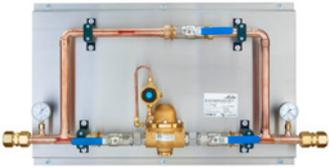
Domdruckregelstation mit Bypass, Absperrkugelhähnen, Vor- und Hinterdruckmanometer, mit Steuerdruckregler (rücksteuerbar, in Atmosphäre entlüftend), komplett montiert auf Wandkonsole aus Edelstahl
