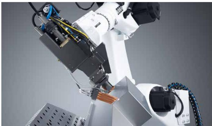
Durch die Möglichkeit, bei Festkörperlasern Lichtleitfasern einzusetzen, werden mehr und mehr Roboter zum Laserschweißen eingesetzt. © TRUMPF GmbH + Co. KG
