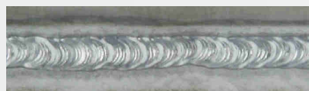
Kehlnaht, 8 mm Blech, AlMg, Argon, 1,2 mm Drahtelektrode, perfekte Schuppung durch superPuls
