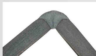
CrNi-Ecknaht 1 mm Blech, mit coldArc.
