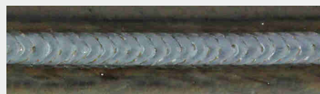
Kehlnaht, 1 mm Blech, AlMg, Argon, 1,2 mm Drahtelektrode
