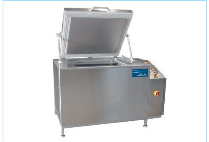
Abbildung 10: Tiefkühltruhe mit Prozesssteuerung: die wirtschaftliche Lösung für kleine, chargenweise zu behandelnde Produktionsmengen
