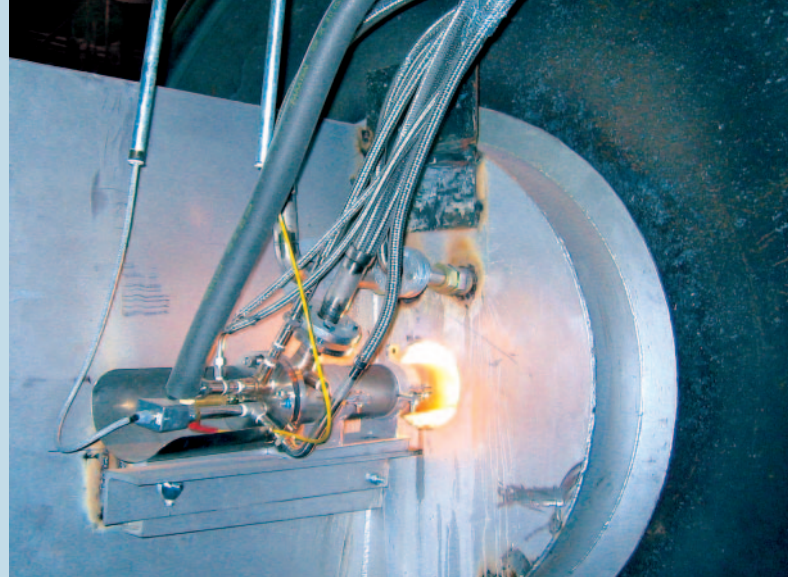
WASTOX®-Sauerstoffanlagen und Oxyfuel-Brenner in einem Zwei-Wege-Brennofen mit doppelter Gasführung (double pass).
