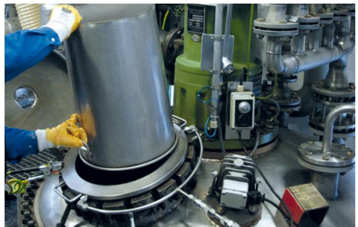
N2LOCK® Inertgasschleuse zum sicheren manuellen Befüllen mit Schüttgütern
