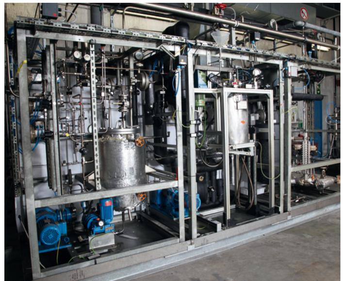
Rührkessel-Technikumsanlage zur Untersuchung von Gas-/Flüssig-Reaktionen
