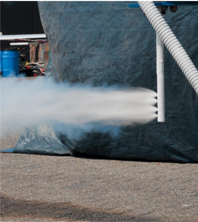
Demonstrationsversuch Flüssigstickstoffeindüsung beim CATCOOL™-Verfahren
