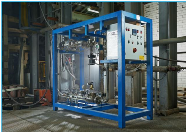
Druck-/Mengenregelstrecke für O<sub>2</sub>, max. 1.000 Nm<sup>3</sup>/h
