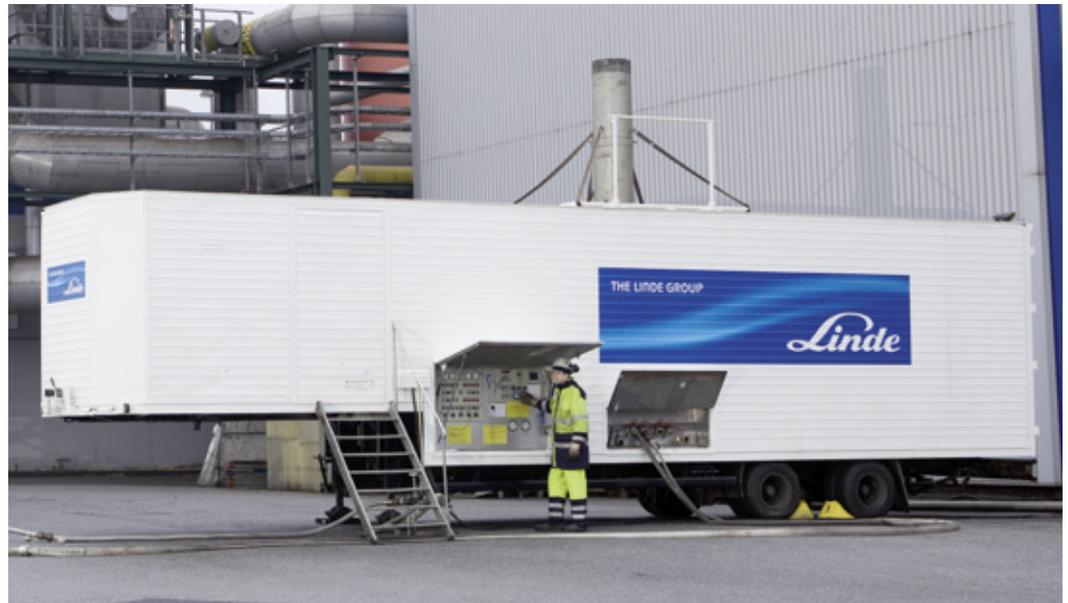
Verschiedene befristete Anwendungsfälle verlangen den Einsatz mobiler Tank- und Verdampfersysteme für die Versorgung mit technischen Gasen. Der dazu benötigte Stickstoff (und andere technische Gase wie Sauerstoff, Argon, Kohlendioxid und Wasserstoff) wird wegen des erheblich kleineren Volumens in tiefkalt verflüssigter Form gelagert und zum Kunden transportiert. Zum Übergang in den gasförmigen Aggregatzustand benötigt man auf den jeweiligen Anwendungsfall abgestimmte Verdampfer.
