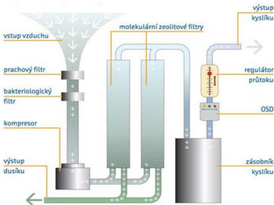
OSD (Oxygen Sensing Device) – systém průběžně sledující koncentraci kyslíku
