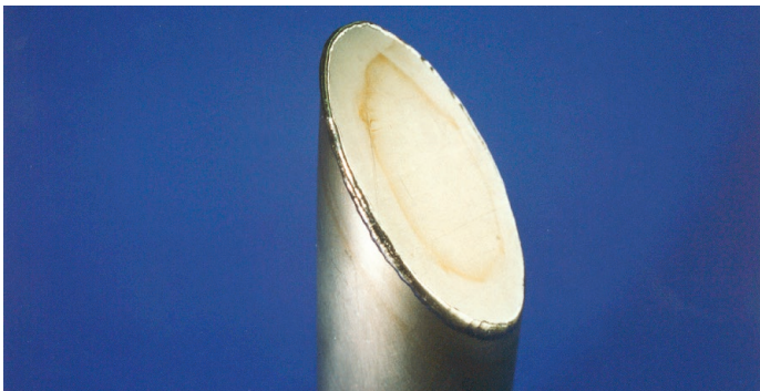
Fig. 8: soudure en angle extérieur TIG sur du Ti-6Al-4V (RUAG Emmen)
