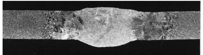
Fig. 6: cordon de soudure TIG avec joint en I, (section 4:1, EMPA à Dübendorf)
