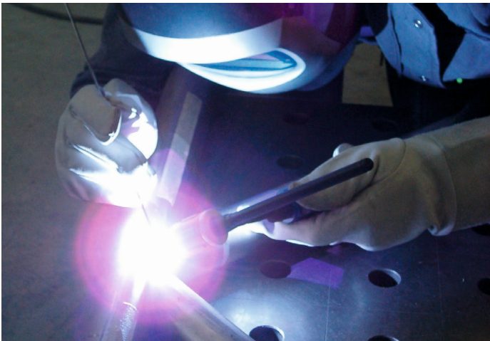
Fig. 5: soudage tungstène-gaz inerte de Ti2 (technique de soudage de l'inox, Zoug)
