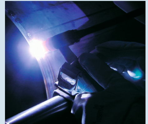
Soudage sous protection Formiergaz
