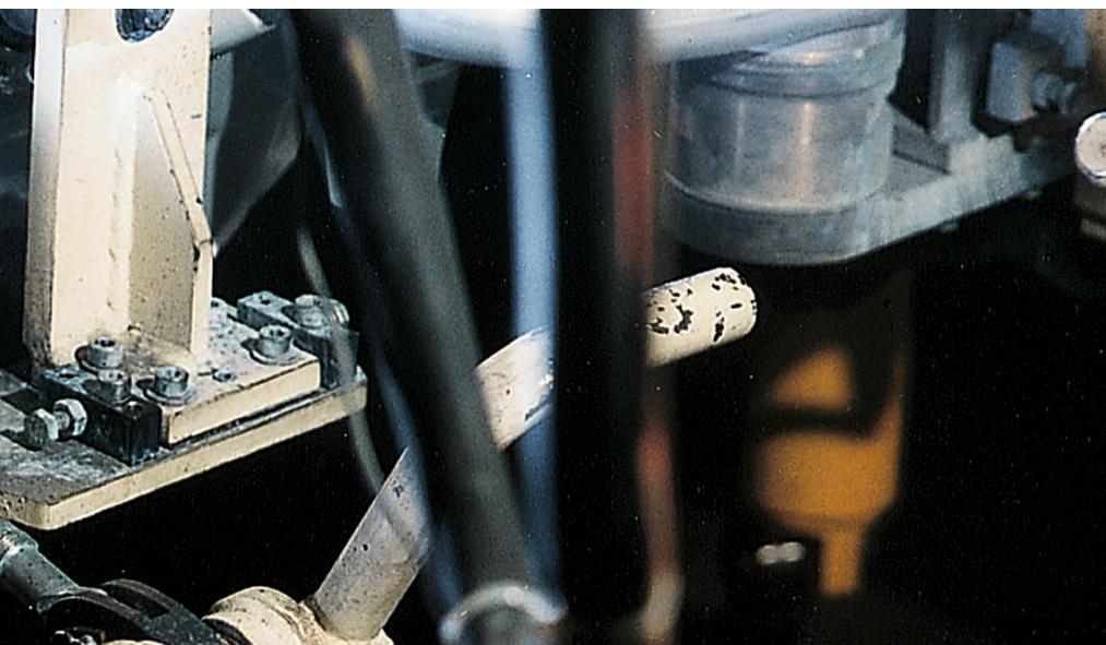
Argon: 20 l/min, 280 A/25 V
