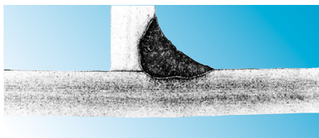
Argon Vitesse de soudage 7 cm/min
