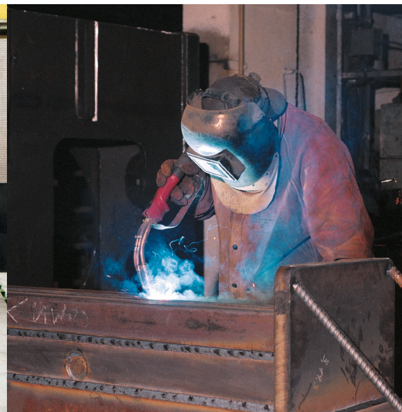
Utilisation de mélanges CORGON® He pour le soudage manuel MAG à haut rendement en construction mécanique lourde
