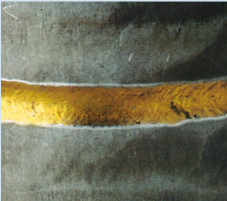
Jaunissement typique: acier CrNi stabilisé au titane (protection envers avec azote)
