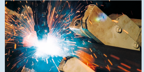
Mélange CORGON® pour les pièces importantes en termes de sécurité en construction automobile
