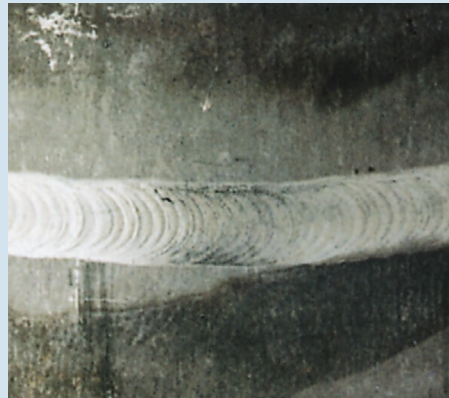
Pas de coloration: acier CrNi stabilisé au titane (protection envers avec HYDRARGON® 7)
