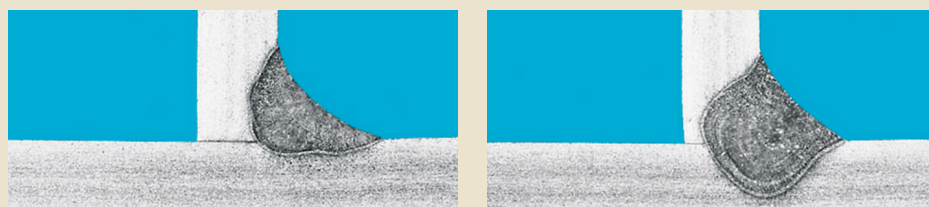
Soudure d'angle réalisée en soudage TIG sous argon
