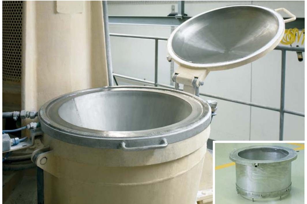
Système N2LOCK® intégré dans le trou de chargement d'un mixeur d'une capacité de 2000 kg.
