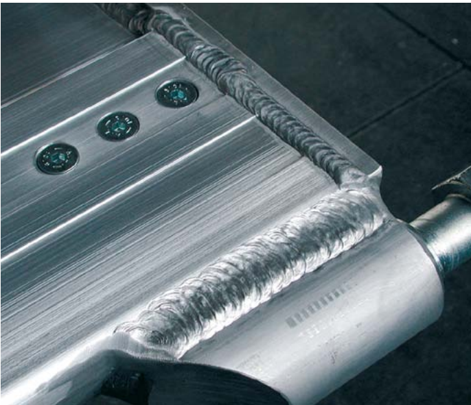
Composant en AlMg4.5Mn, soudage TIG avec SG-AlMg4.5Mn sous MISON® He20
