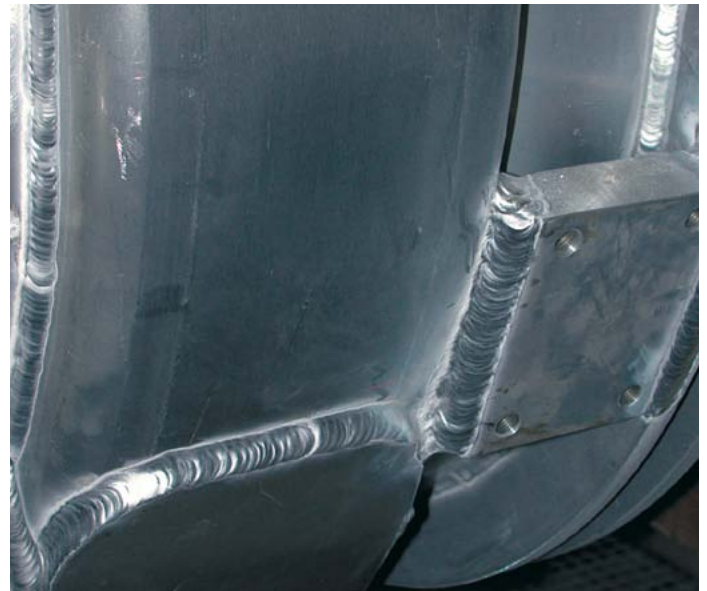
MISON® He20: soudure TIG sur un réservoir en aluminium
