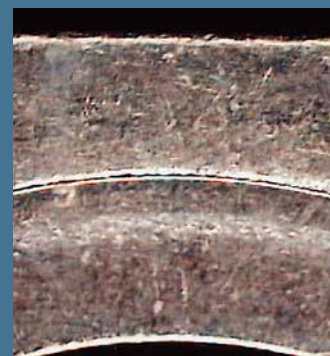
Etat de surface lors d'un traitement sousprotection gazeuse à l'hydrogène pur
