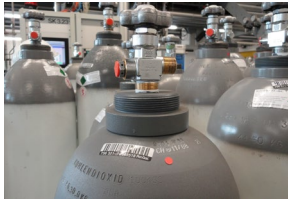
Bouteille de CO 2 pour prélèvement à l'état gazeux (sans tube plongeur)
