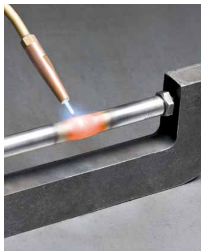
Illustration 4.26 Effet de refoulement lors de la chauffe de retrait
