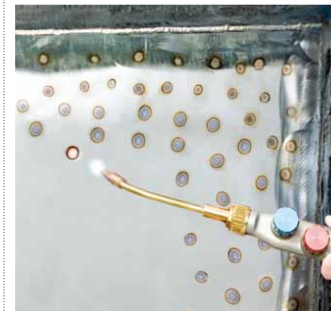
Illustration 4.34 Chaud de retrait sur un panneau de tôle
