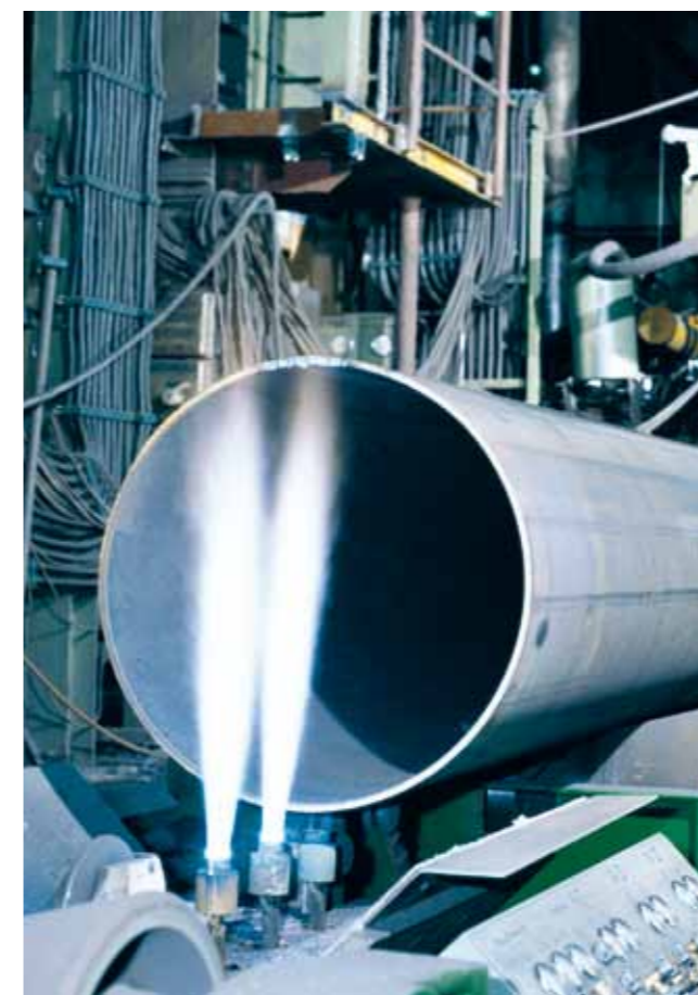
Illustration 4.30 Utilisation d'un chalumeau spécial pour lignes de chauffage
