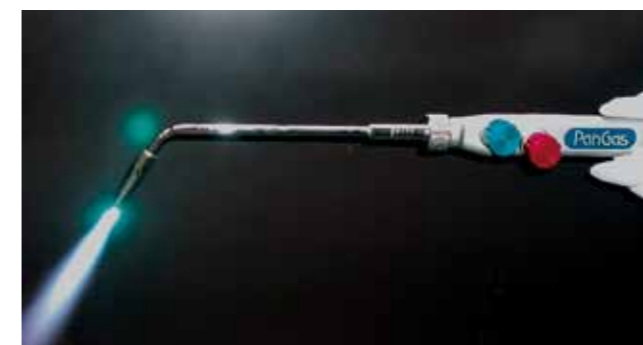
Illustration 4.29 Chalumeau spécial pour points de chauffage
