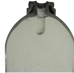
Coupe d'une bouteille de C 2 H 2
