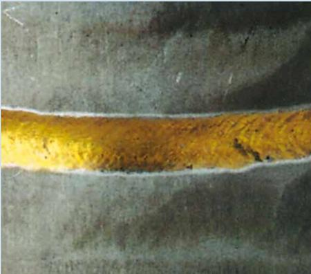
Jaunissement typique: acier CrNi stabilisé au titane (protection envers avec azote)
