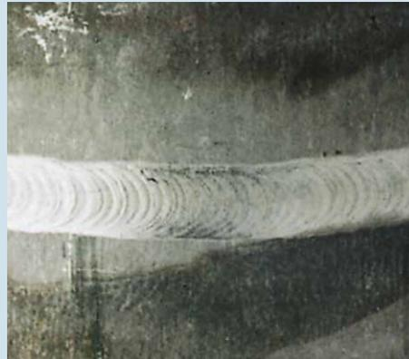
Pas de coloration: acier CrNi stabilisé au titane (protection envers avec HYDRARGON® 7)
