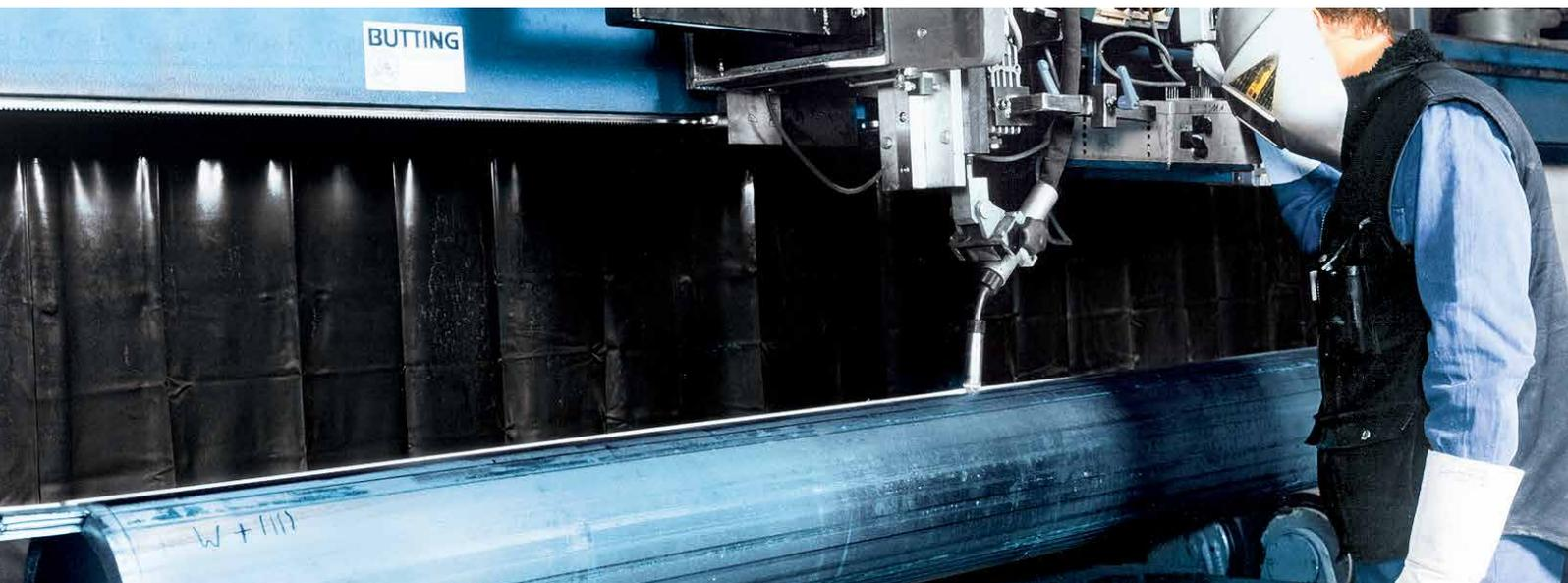
Les gaz de protection spéciaux de Linde permettent aussi le soudage MSG des aciers réfractaires fortement alliés
