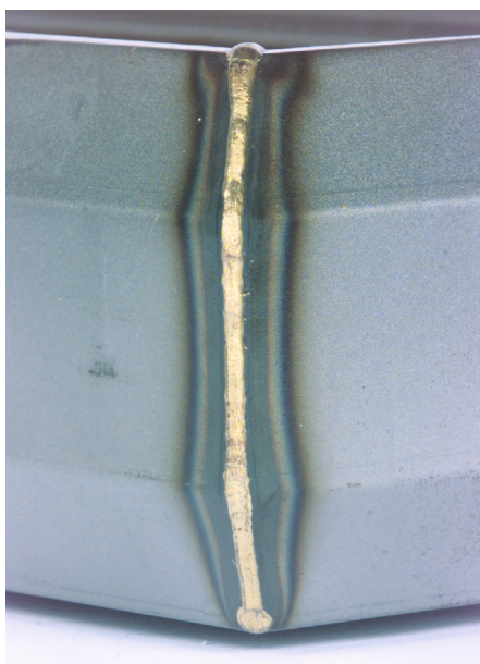
Construction en tôle mince soudo-brasée selon le procédé MSG
