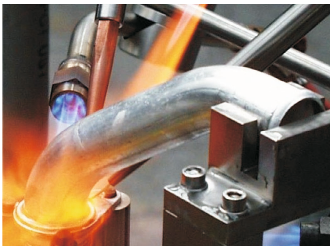
Brasage à joint capillaire avec apport automatique de brasure (photo: Everwand & Fell)
