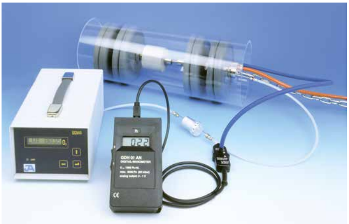
Dispositif de mesure de la teneur résiduelle en oxygène, photo: Jankus
