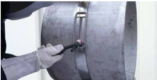
Fermeture du joint soudé durant le soudage, photo: Jankus
