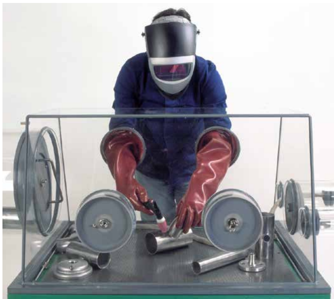
Chambre pour soudage sous atmosphère inerte, photo: Jankus
