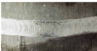
Acier inoxydable stabilisé au titane: protection avec Ar/H 2
