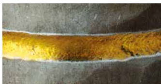
Acier inoxydable stabilisé au titane: coloration jaune sous N 2 /H 2
