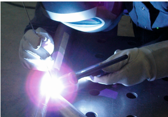
Abb. 5: WIG-Schweissen von Ti2 (INOX-Schweisstechnik, Zug)
