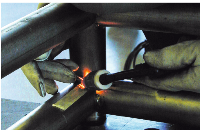
Abb. 3: Rohrkonstruktion aus Ti2 (INOX-Schweisstechnik, Zug)
