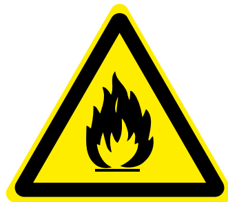
Warnung vor feuergefährlichen Stoffen
