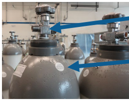
CO 2 -Steigrohrflaschen (mit Steig- oder Tauchrohr)
