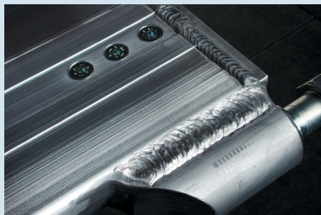
MISON® He20: MIG-Schweisnähte an Fahrzeug-Aufbau
