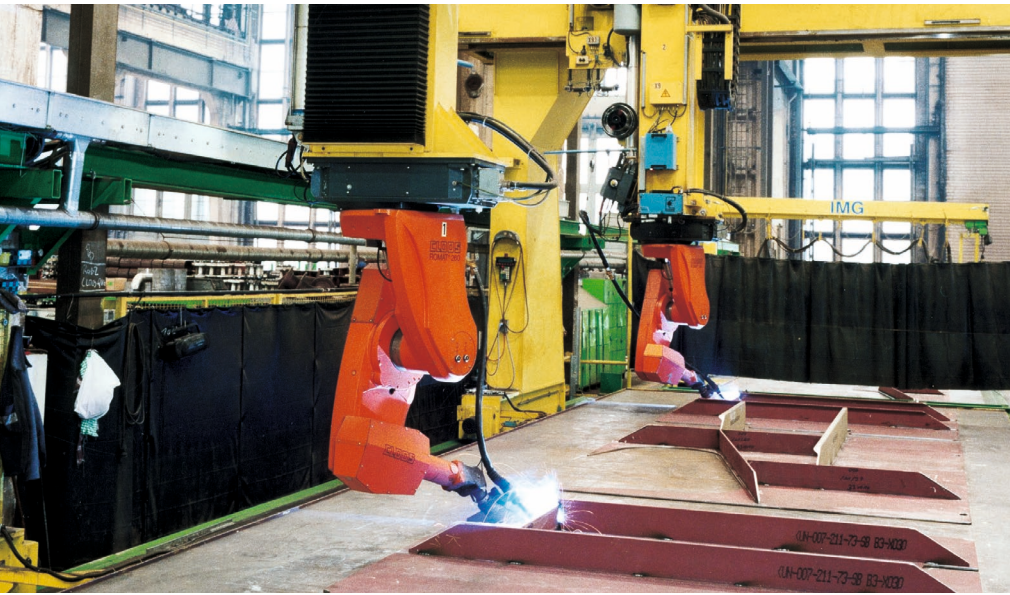
Einsatz von CORGON® 15/5 beim MAG-Roboterschweissen
