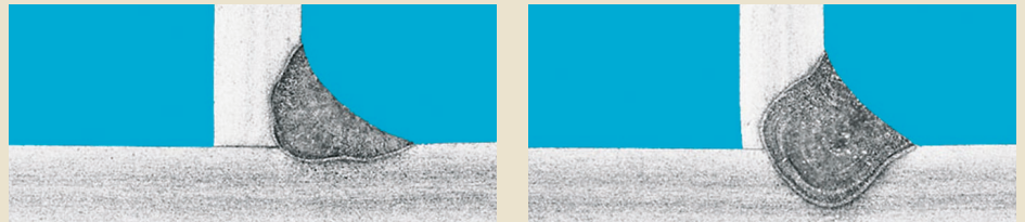
Kehlnaht, mit Argon WIG-geschweisst
