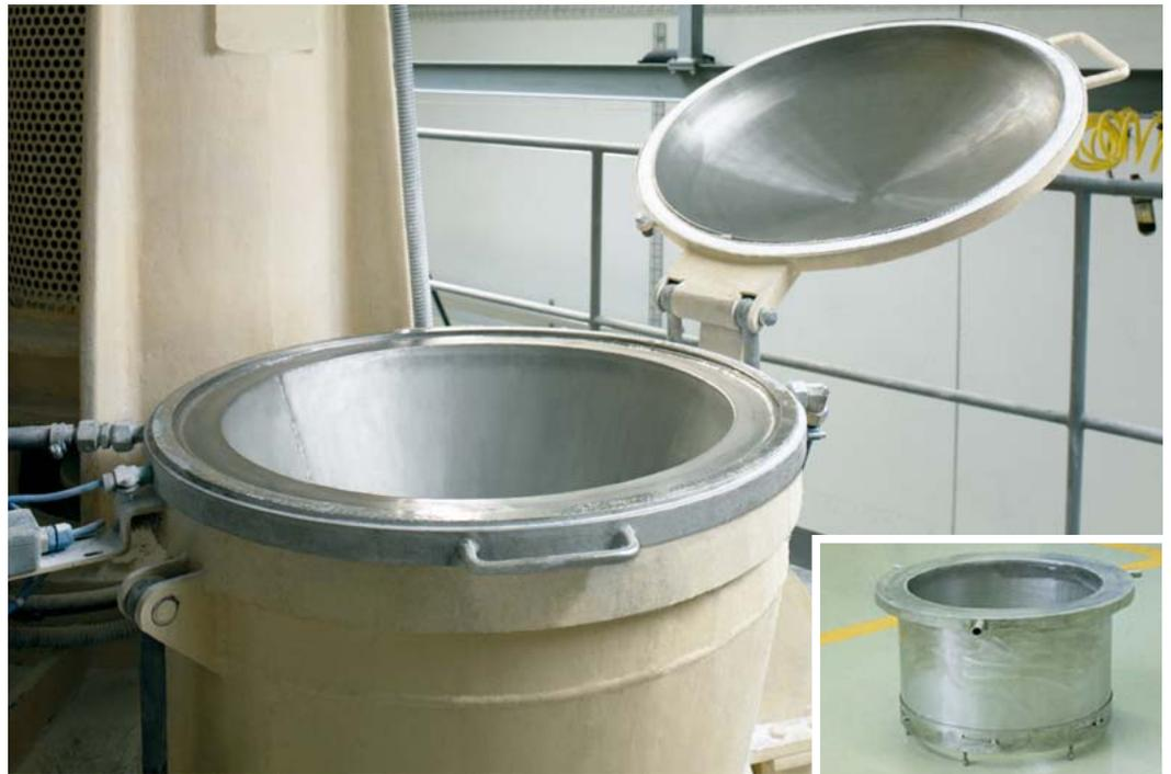
In die Befüllöffnung eines Mixers mit 2000 kg Fassungsvermögen integriertes N2LOCK®-System.
