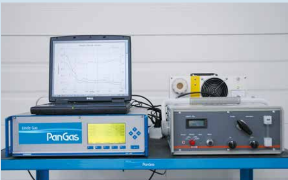
Analysensystem zur Messung der Ofenatmosphäre
