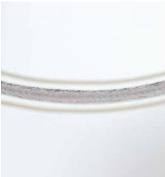
Bild 9: Typische Verfärbung neben der Naht, sog. «Manganfahne»
