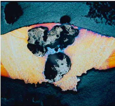
Bild 1: Fortgeschrittene Lochkorrosion im Schweißgut einer WIG-Schweißverbindung an nichtrostendem Stahl (Quelle: SLV München)
