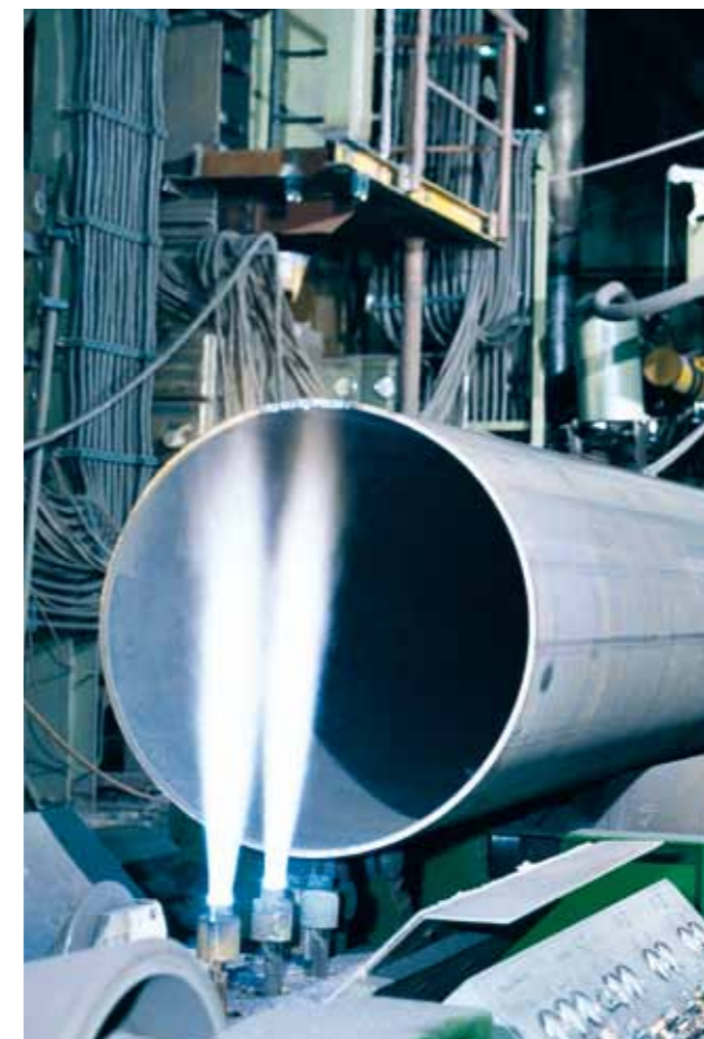
Bild 4.30 Einsatz eines Sonderbrenners für Wärmestriche
