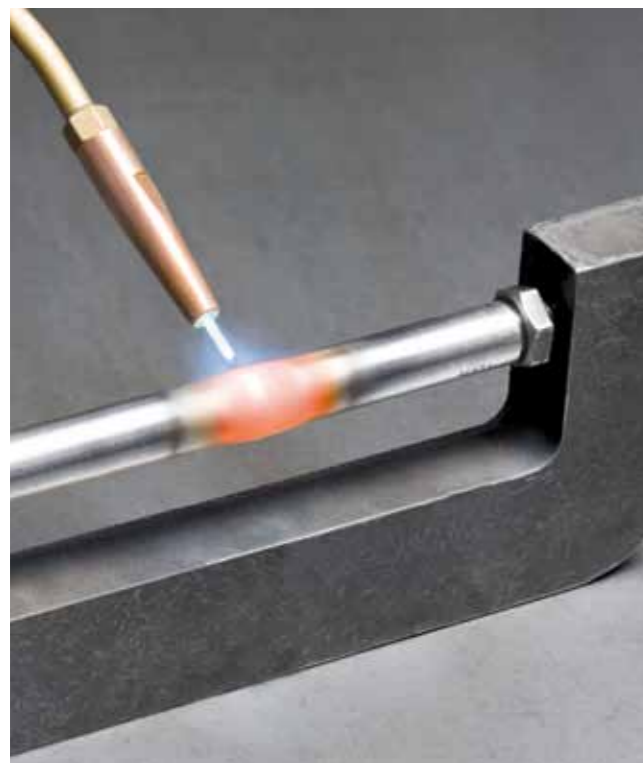
Bild 4.26 Stauchwirkung beim Flammrichten
