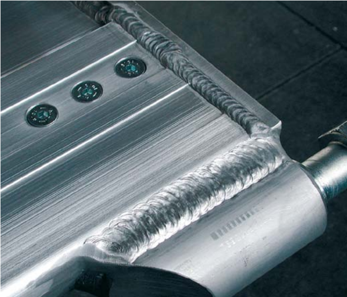
Bauteil aus AlMg4.5Mn, WIG-geschweisst mit SG-AlMg4.5Mn unter MISON® He20
