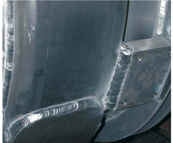
MISON® He20: MIG-Schweissnaht an Aluminium-Behälter
