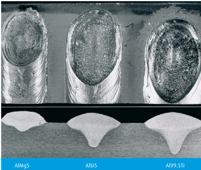
Unterschiedliche elektrische Leitfähigkeit wirkt auf Einbrand und Nahtform
