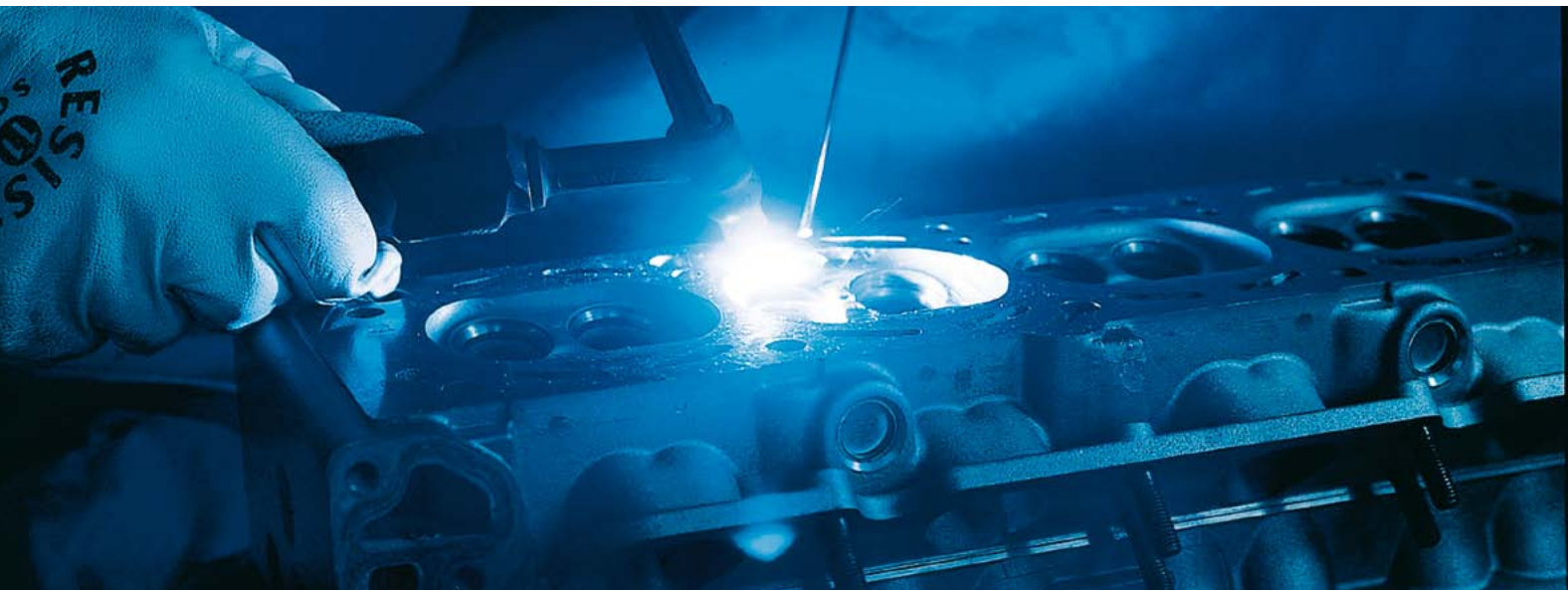
WIG-Gleichstrom-Schweißen mit minusgepolter Elektrode
