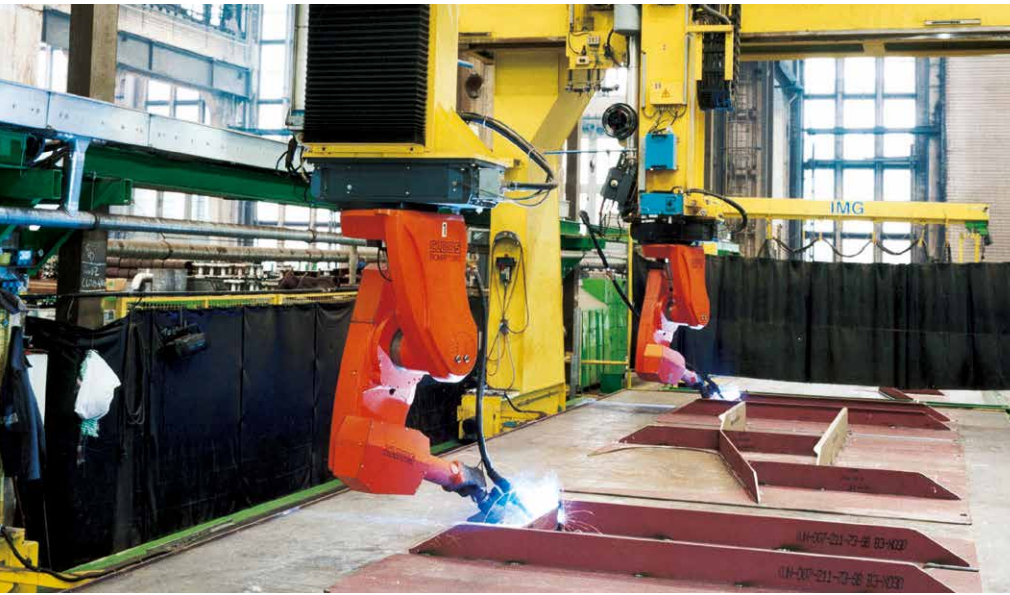
Einsatz von CORGON® 15/5 beim MAG-Roboterschweissen
