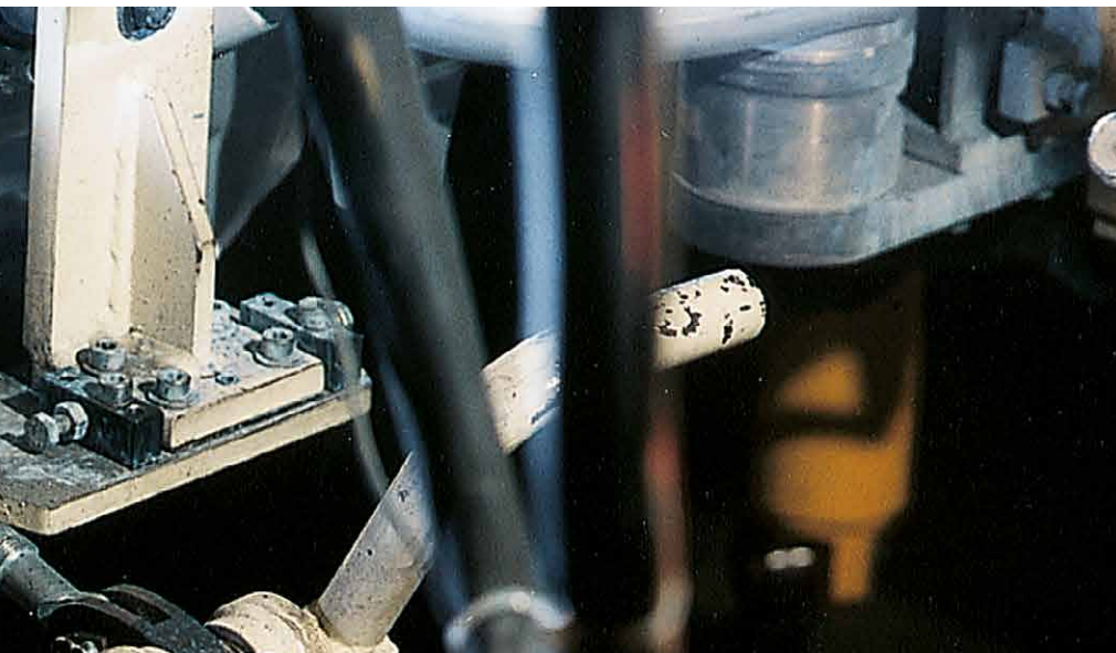
Argon: 20 l/min, 280 A/25 V
