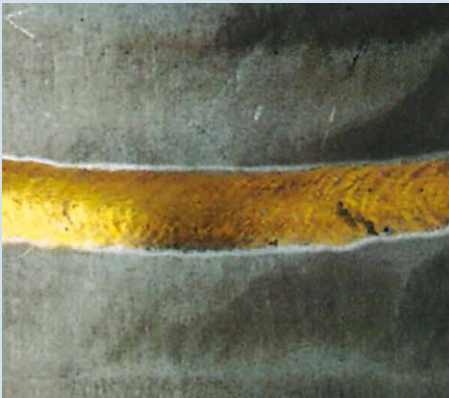
Typische Gelbfärbung: titanstabilisierter CrNi-Stahl, formiert mit Stickstoff
