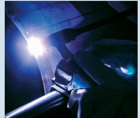
Schweißen unter Formiergasschutz mit HYDRARGON® 7
