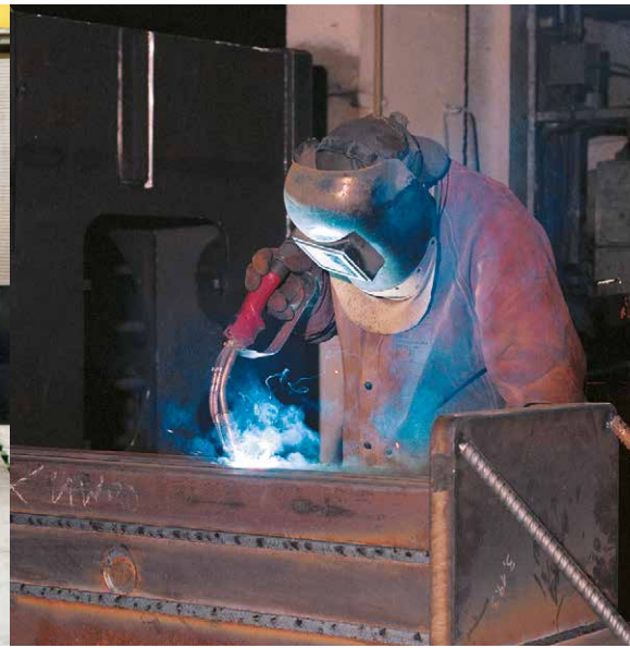
Manuelles MAG-HL-Schweissen im schweren Maschinenbau mit CORGON® He-Gemischen
