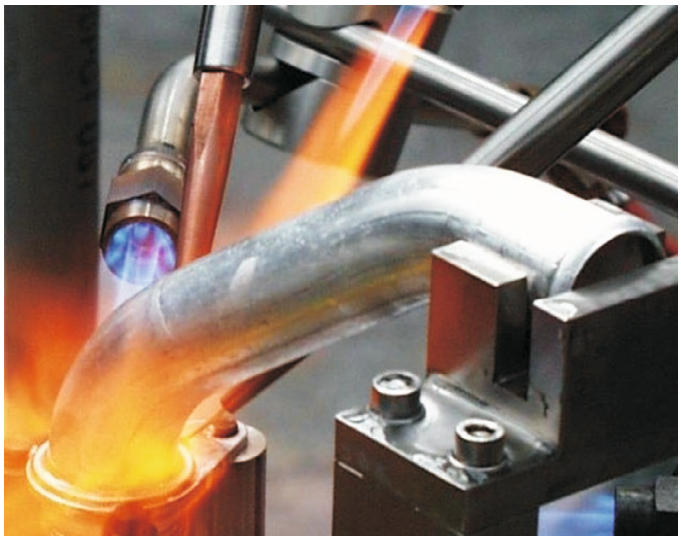
Mechanisertes Spalllöten mit automatischer Lotzufuhr
