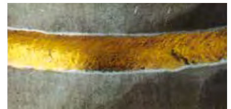
Titanstabilisierter Rostfrei-Stahl: Gelbfärbung unter N 2 /H 2
