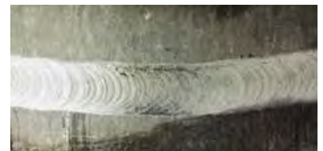
Titanstabilisierter Rostfrei-Stahl: formiert mit Ar/H 2
