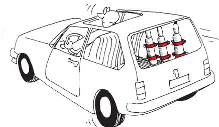
Bewährt als Einrichtungen zur Ladungssicherung haben sich z.B. spannbare Gurte, die an genügend stabilen Fahrzeugteilen befestigt werden müssen. In der Nähe der Stirnwand des Fahrzeuges sind die Gasflaschen quer zur Fahrtrichtung liegend oder stehend zu laden. Bündel oder Paletten sollen diagonal gesichert werden. Mehr darüber ist in der Broschüre „Ladungssicherung bei der Beförderung von Gasen in Druckgefäßen mit Straßenfahrzeugen“ nachzulesen, die über unsere Servicestellen erhältlich ist.
